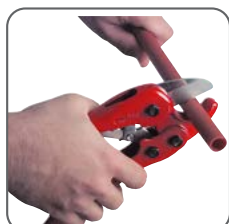
1 - Couper le tube proprement.
